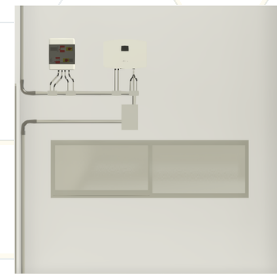
VISTA: CONEXÃO DO INVERSOR
